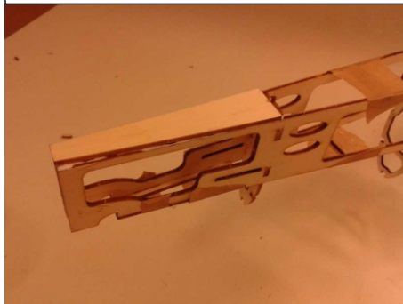
43. A hátsó futóplatni ragasztása.
